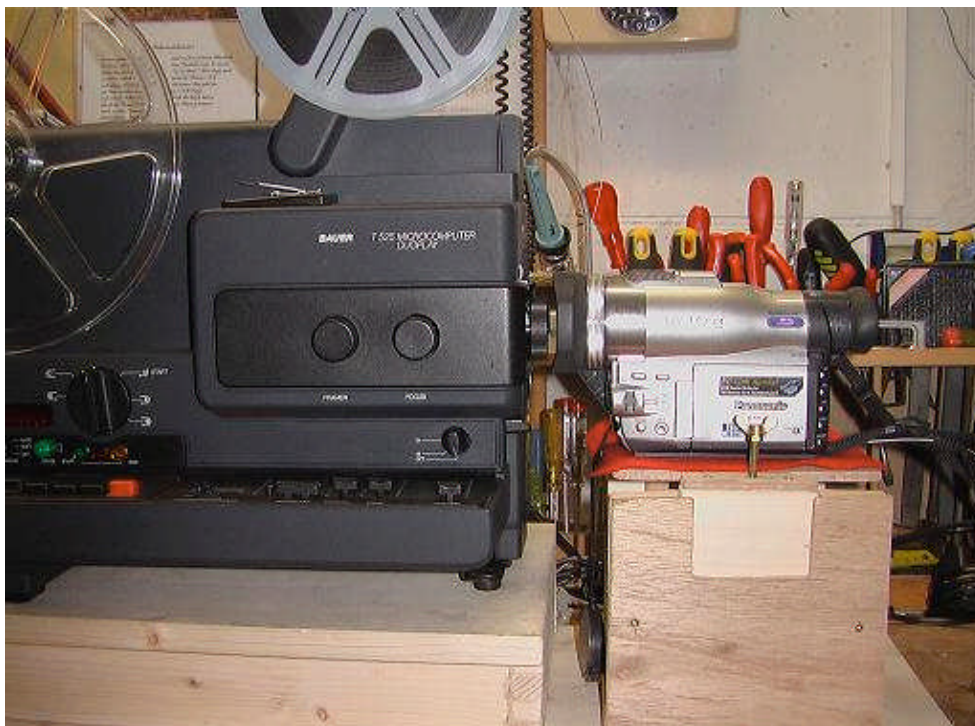
Abbildung 1 Positionierung Projektor und Camcorder
