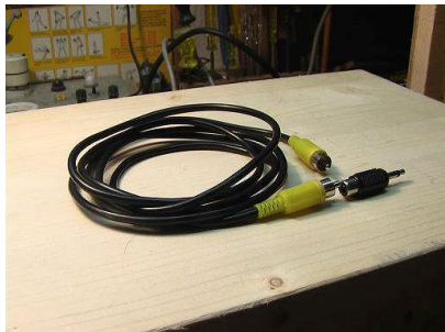
Abbildung 4 Synchronkabel mit Adapter
