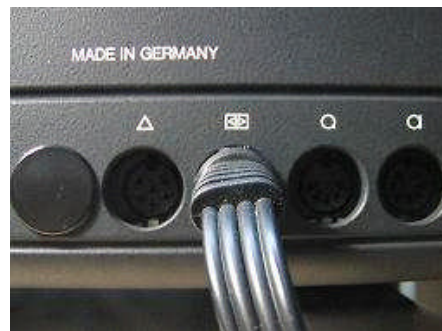
Abbildung 3 Anschluss Verstärkerausgang Projektor
